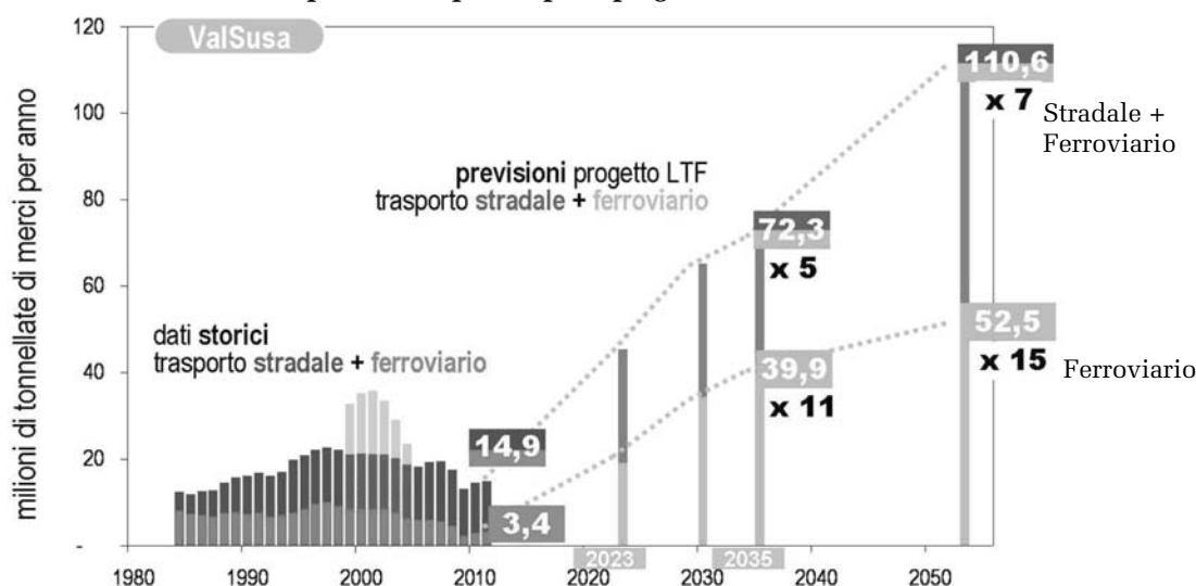
Figura 3. Variazione negli anni del traffico stradale e ferroviario sulla direttrice Torino Lione: a sinistra i dati storici, a destra le previsioni riportate per il progetto della nuova linea ferroviaria NLTL.
